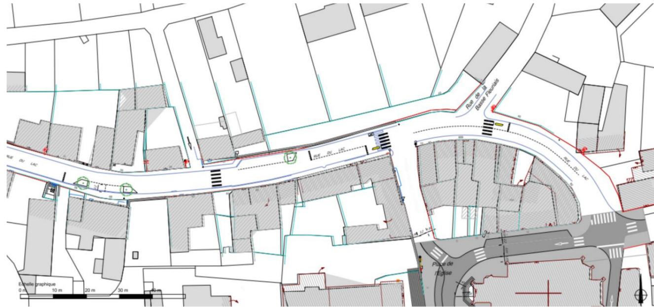
Plan d'aménagement du scénario 1 : conservation du profil de voirie avec mise en place de solutions légères ponctuelles pour assurer la sécurité routière, en attente de la voie nouvelle permettant le contournement des véhicules supérieurs à 3,5t.
