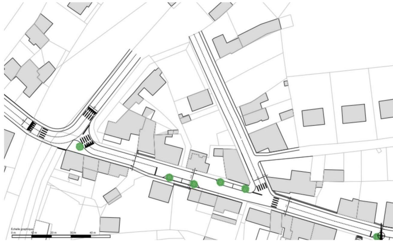
Plan d'aménagement du scénario 2 avec une chaussée double sens de 5,50m avec réduction à 3,5m au droit des stationnements en chicane avec cédez-le-passage, trottoirs de 1,40m et plateau surélevé de la voie verte et du carrefour de la rue du Général De Gaulle.
