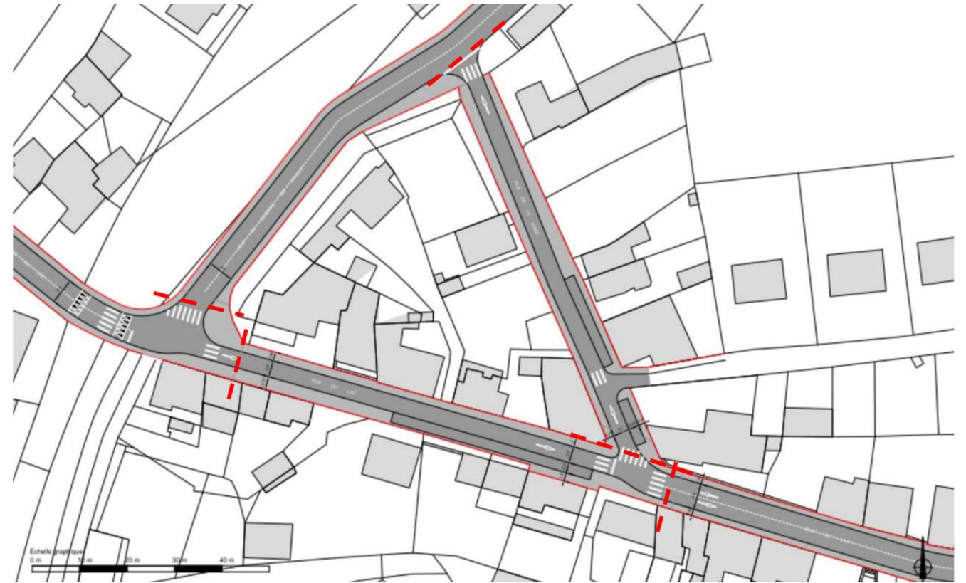
Plan d'aménagement retenu pour la partie basse et la rue de la gare, permettant la mutation du bâti vacant en partie basse, en fonction de l'opération de logements réalisée.
